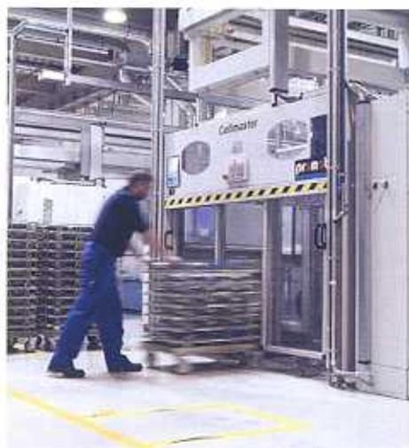
Die Behälterstapel dienen gleichzeitig als Pufferspeicher zwischen den Maschinen
