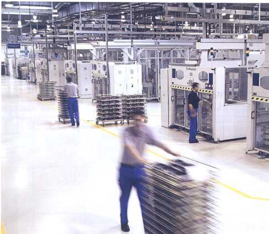
Der innerbetriebliche Transport erfolgt durch Behälterstapel auf Bodenrollern
